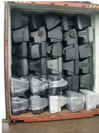
Obrázek 8 – Nevyhovující – Zásilka je uspořádaná, ale elektrozařízení nejsou samostatně balena a vhodně zafixována
