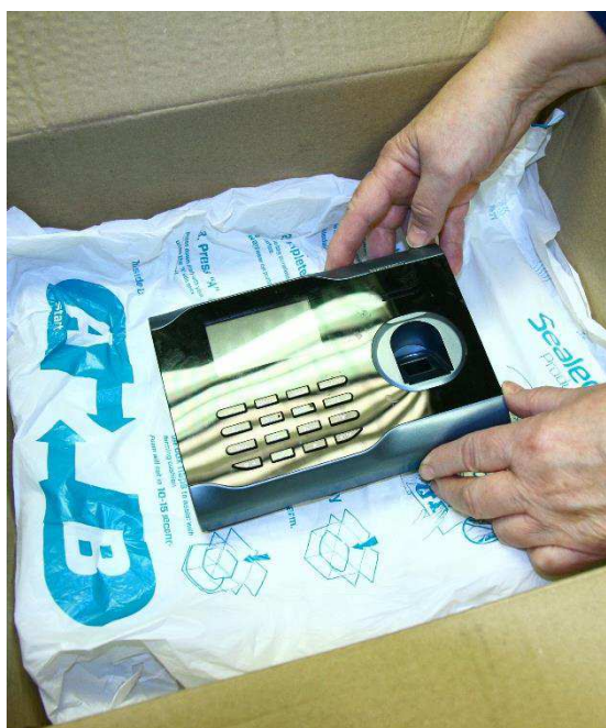
Obrázek 1 – Fixace elektrozařízení v obalu pomocí pěnových fólií
