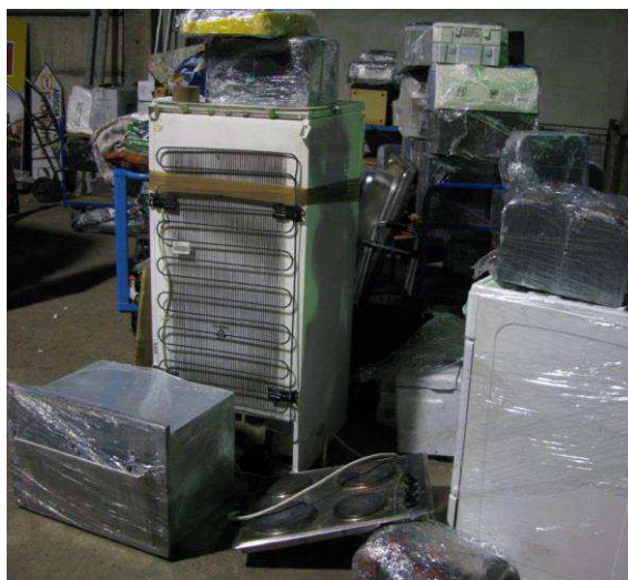
Obrázek 10 – Nevyhovující – Jednotlivé kusy jsou zabalené pouze do strečových fólií nebo nejsou zabaleny vůbec
