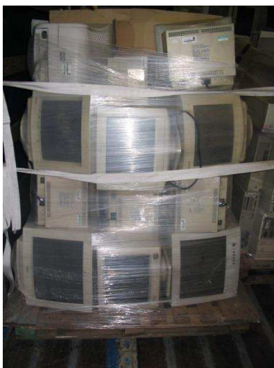
Obrázek 9 – Nevyhovující – Paleta je obalena strečovou fólií a zajištěna fixačním pásem, ale nejsou zabaleny a zabezpečeny jednotlivé kusy elektrozařízení a jejich citlivé části
