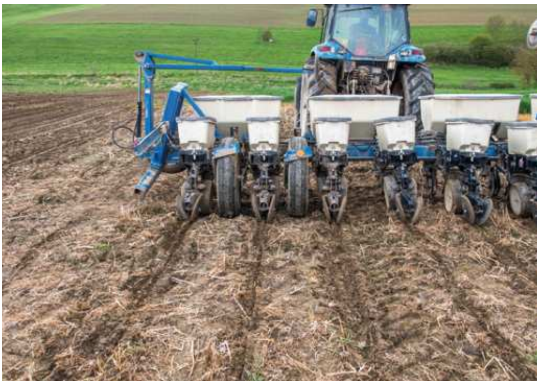
Obr. 1-16. Výsev kukuřice bezorebným secím strojem do vymrzající meziplodiny
