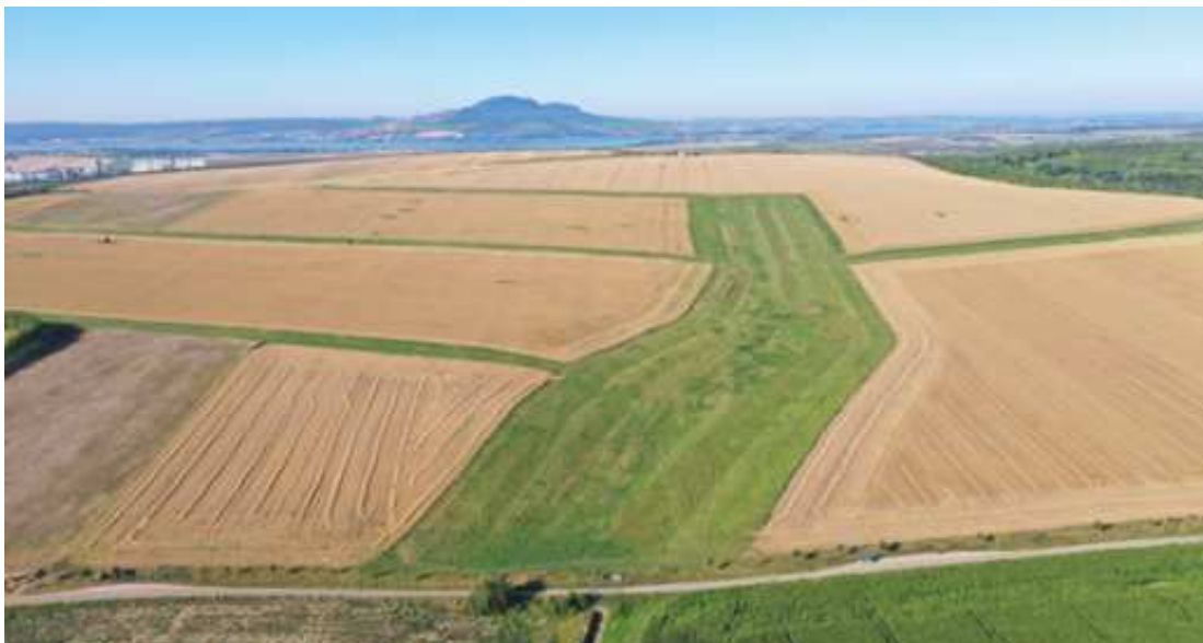
Obr. 1-43. Stabilizovaná dráha soustředěného odtoku u k. ú. Starovice
