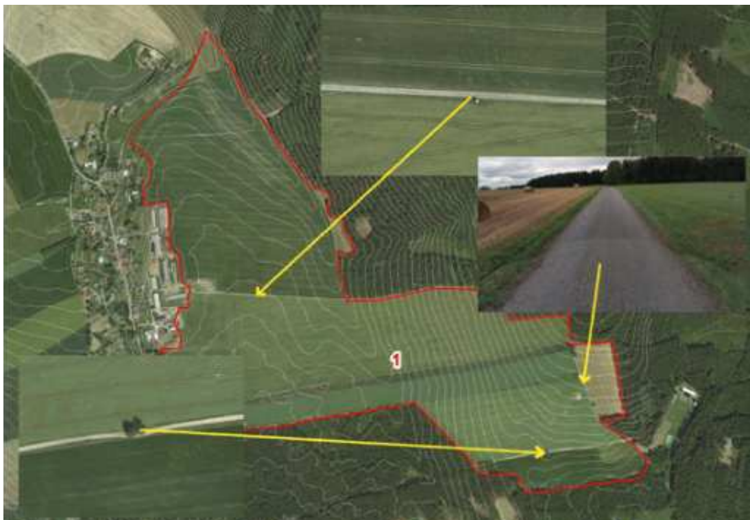
Obr. 6-4. Ukázka polních cest v ploše pro výpočet eroze (červeně), které nepřerušují délku svahu (nejsou doplněny příkopem či jiným technickým prvkem) (© ČÚZK)
