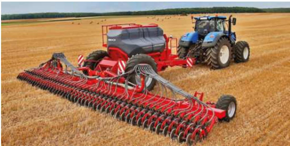
Obr. 1-15. Výsev bezorebným secím strojem do strniště předplodiny
