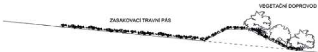
Obr. 1-38. Vzorový řez – Protierozní hrázka se záchytnou a usakovací funkcí se zasakovacím travním pásem a vegetačním doprovodem
