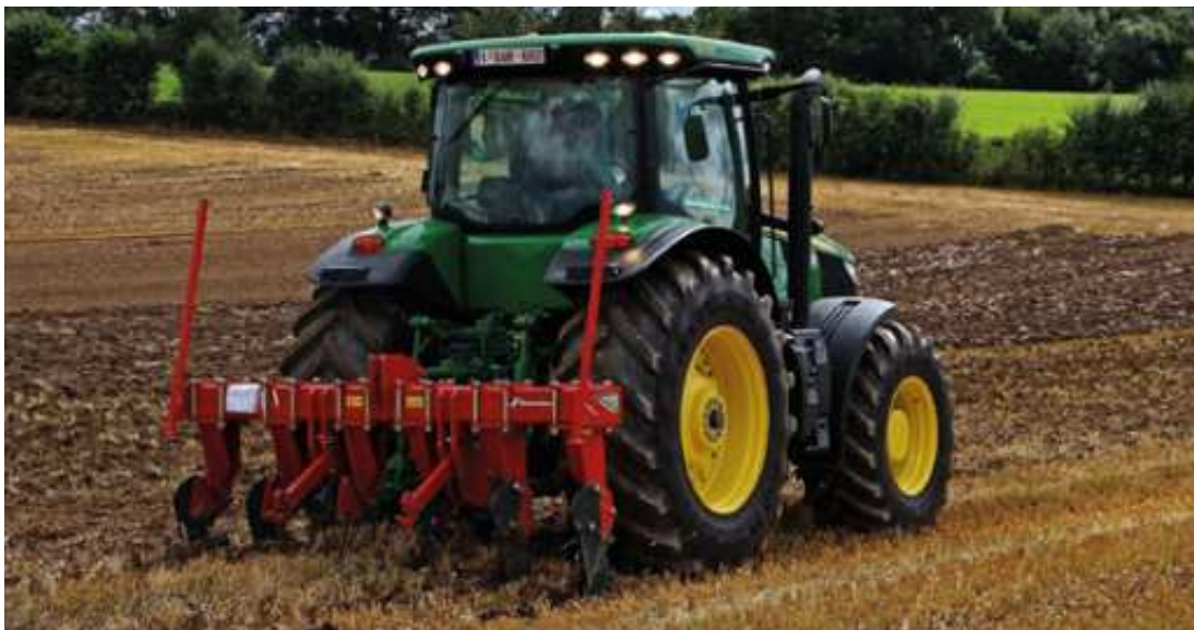
Obr. 1-26. Půdochranná technologie podrývání
